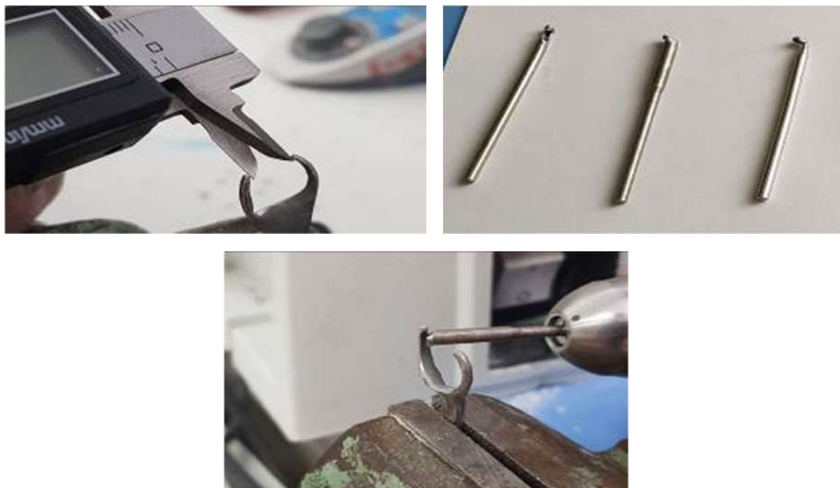
Рисунок 1 - Штангенциркуль; эксцентрики (длиной плеча 0,25; 0,5; 0,75); зуботехнический шлейф мотор
